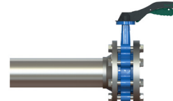
Démontage aval sur brides (avec contre-bride impérative)
