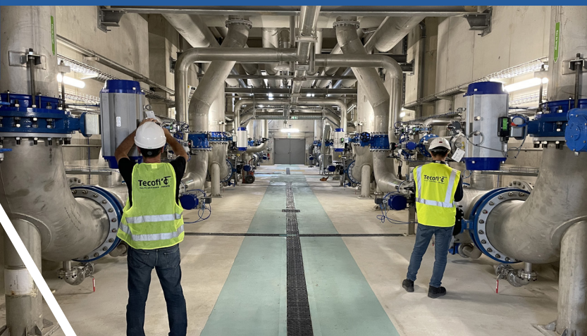
Banc / Bench 1 : DN50 à /to DN 300 Banc / Bench 2 : DN350 à /to DN 800 Banc / Bench 3 : DN700 à /to DN 1600
