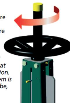
En cas de stockage prolongé ou de faible fréquence des manœuvres, graisser la vis de manœuvre régulièrement.
