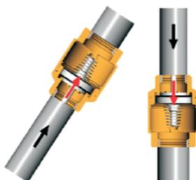
**Clapet à soupape / Lift check valve**
