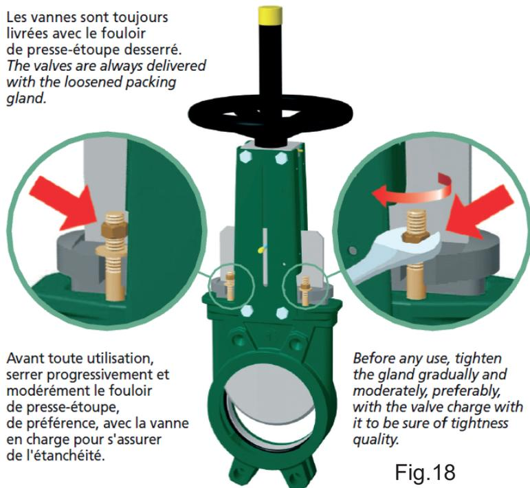
Avant toute utilisation, serrer progressivement et modérément le fouloir de presse-étoupe, de préférence, avec la vanne en charge pour s'assurer de l'étanchéité.
