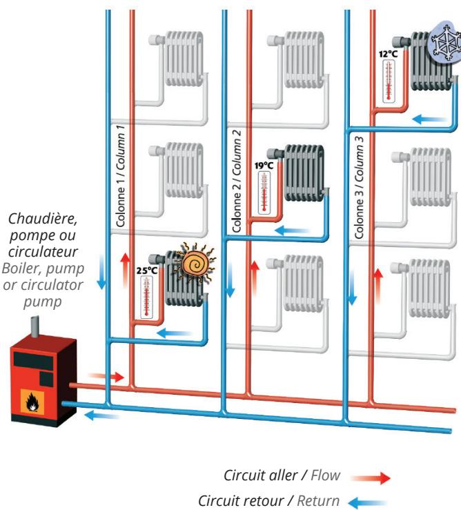
Pour équilibrer l'installation, on monte des Robinets d'équilibrage RC 2106 sur les circuits de retour. Ceux-ci vont répartir équitablement les débits dans les colonnes.
