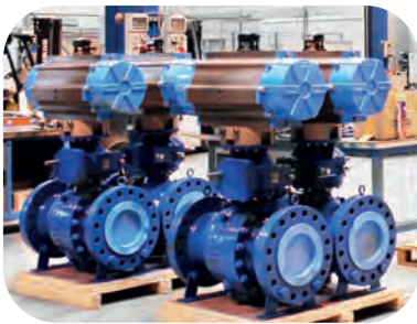
Vannes à boisseaux sphériques PN100 avec actionneur pneumatique double effet et commande manuelle de secours.
