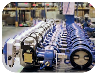
Vannes à papillon équipées de vérin pneumatique double effet avec commande manuelle de secours et électrodistributeur.
