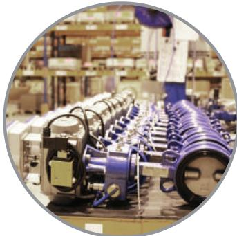
Vannes papillon équipées de vérin pneumatique double effet avec commande manuelle de secours.
