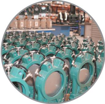
Vannes guillotines DN 150 à vérin pneumatique avec trous de soufflage pour alimentation d'air.
