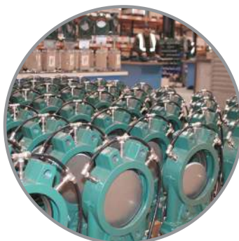
Шиберная ножевая задвижка Ду150 с пневмоприводом и с продувными отверстиями для очистки седла подачей воздуха под давлением.
