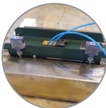
Установка и регулировка концевых выключателей и соленоидного клапана на шиберную ножевую задвижку с пневмоприводом двойного действия Ду250
