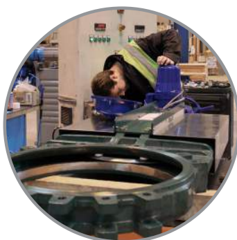
Установка и регулировка электропривода на шиберную ножевую задвижку Ду500
