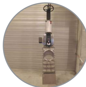
Шиберная задвижка из нержавеющей стали со сквозным ножом Ду300. Управление: пневмопривод с электро-пневматическим позиционером и с аварийным штурвалом управления.
