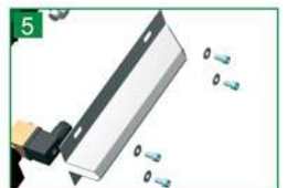
Защитная пластина из нержавеющей стали, регулируемая по высоте (маркировка CE) Монтаж производится на стальные пластины или на части из нержавеющей стали Security protections Adjustable height of stainless steel protection (CE marking) Assembling on epoxy coated steel or stainless steel pre-shaped parts.
