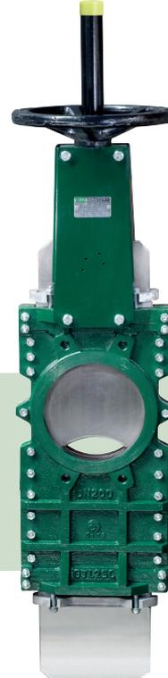
Cette vanne en deux parties s'adapte particulièrement à la papeterie, en sortie de pulpeur, elle ne représente pas de zone de rétention en position ouverte. Le principe de déplacement de la pelle s'apparente au fonctionnement d'un « coupe cigare ».
