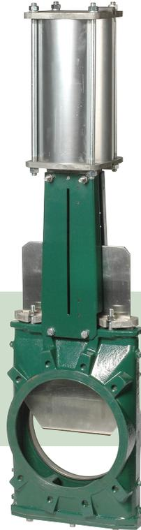
Cette vanne guillotine a été spécialement développée pour un montage sous silo. Le corps allongé et large empêche l'accumulation de produits dans les zones de rétention. Les trous de soufflage permettent de nettoyer l'intérieur du corps, au moment de la manoeuvre pour éviter le coincement de la pelle.
