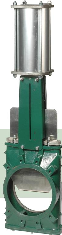
Esta válvula de guillotina se instala bajo los silos. El cuerpo ancho y alargado evita la acumulación de productos en las zonas de retención. Los agujeros de soplado permiten la limpieza del interior del cuerpo, en el momento del mantenimiento.
