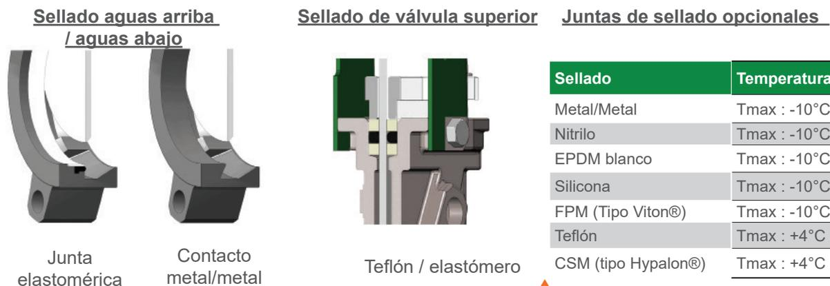
⚠ Para garantizar un sellado satisfactorio, en caso de utilización de una junta de asiento en teflón, la presión de servicio debe ser de al menos 1 bar.
