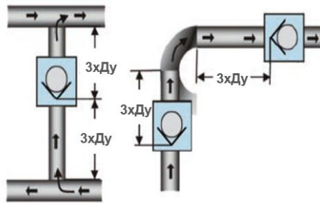
Турбулентный поток может привести к высоким нагрузкам на диске, в результате чего сокращается срок службы или клапан выходит из строя. После запуска системы убедитесь в отсутствии протечек в местах межфланцевого присоединения. Обеспечьте достаточное пространство вокруг клапана для будущих работ по техническому обслуживанию.
