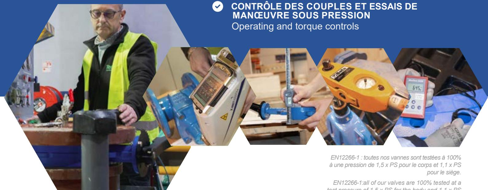
EN12266-1 : toutes nos vannes sont testées à 100% à une pression de 1,5 x PS pour le corps et 1,1 x PS pour le siège.
